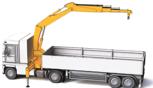
Grue de chargement montée derrière la cabine
